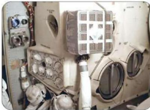
دستگاه واکنش کربن دی اکسید با لیتیم هیدروکسید در فضاپیما
