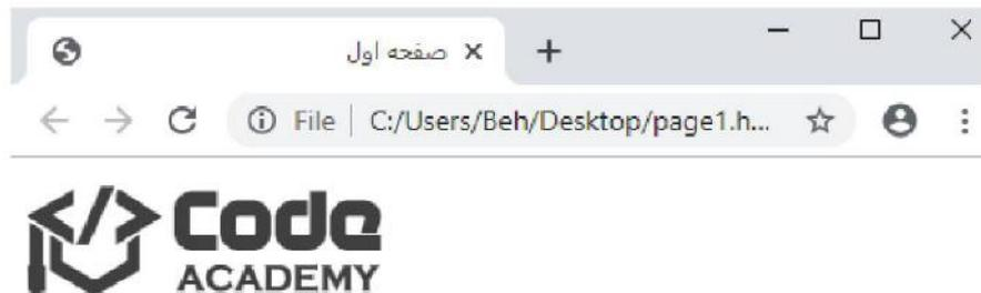
بنابراین با استفاده از تگ <img> و تنظیم خاصیت آن به نام src می توانیم یک تصویر ایجاد کنیم.
