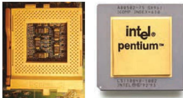
شکل ۲۸-۳ پردازنده پنتیوم ۷۵ و سوکت شماره ۵
