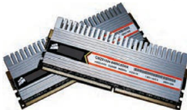
شکل ۴-۱۷ حافظه اصلی DDR2 با ظرفیت یک گیگابایت و فرکانس پالس ساعت ۸۰۰ مگاهرتز
