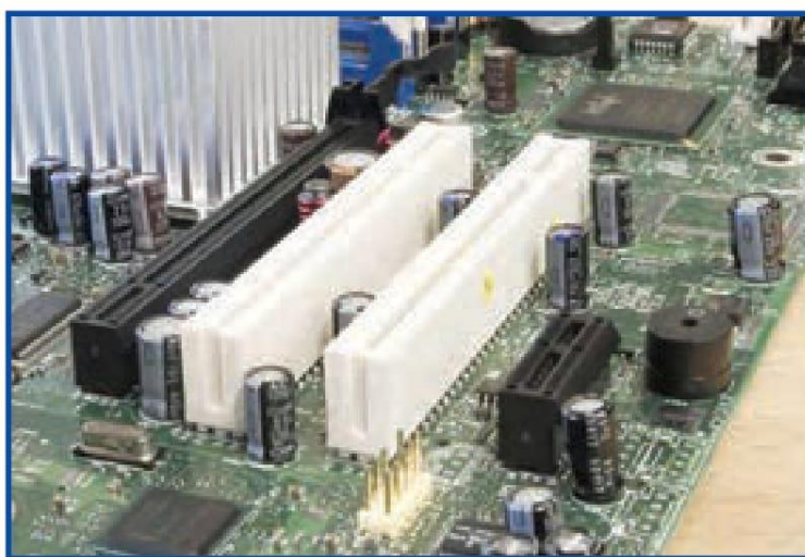
شکل ۲۷-۲ دو شکاف توسعه PCI به رنگ سفید و دو شکاف توسعه PCI-E به رنگ مشکی که سمت چپ 16x و سمت راست 1x هستند.
