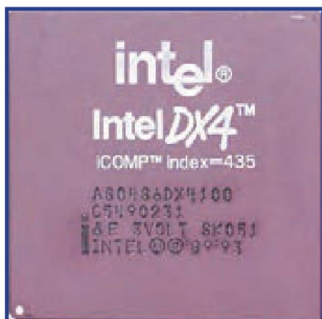
شکل ۲۳-۳ پردازنده ۴۸۶ DX ۴/۱۰۰ با سرعت ۱۰۰ مگاهرتز و سوکت شماره ۳
