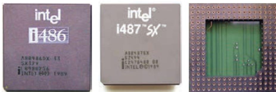
شکل ۲۲-۳ پردازنده ۸۰۴۸۶ DX محصول شرکت اینتل با فرکانس پالس ساعت ۳۳ مگاهرتز، کمک پردازنده اولیه ۸۰۴۸۷ و سوکت شماره یک
