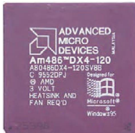
شکل ۳-۲۵ پردازنده AM486 DX4 از شرکت AMD مشابه خانواده Intel 486 DX با سرعت ۱۲۰ مگاهرتز
