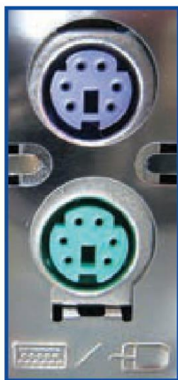
شکل ۱۱-۲ دو کانکتور PS/2 برای اتصال صفحه‌کلید و ماوس در پشت کیس و سر کابل صفحه‌کلید
