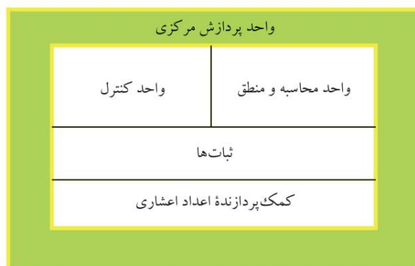
شکل ۱-۶ بخش‌های واحد پردازش مرکزی
