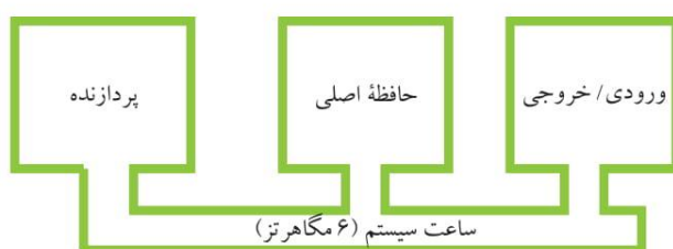
شکل ۲۰-۲ گذرگاه واحد در رایانه‌های اولیه، نسل XT، ساختار اصلی یک گذرگاه و با یک سرعت معین
