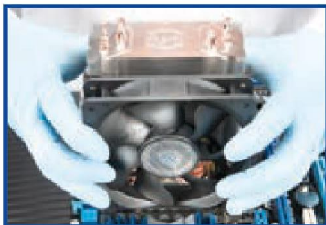
شکل ۸-۹ نصب خنک کننده پردازنده
