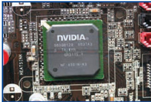
شکل ۵-۲ مدار واسط گرافیکی که به صورت سرخود روی برد اصلی وجود دارد
