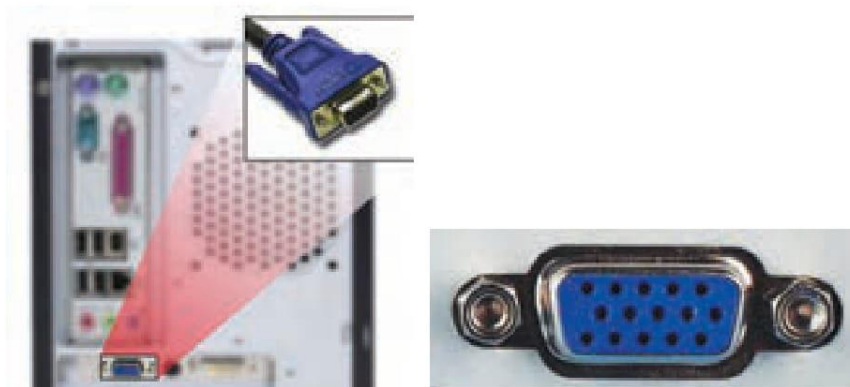
شکل ۱۵-۵ درگاه خروجی ۱۵ پین VGA برای اتصال به صفحه‌نمایش‌های آنالوگ
