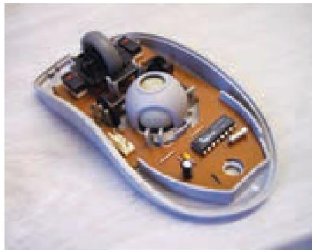
شکل ۲۶-۶ درون ماوس مکانیکی - نوری
