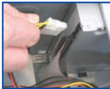
شکل ۲۳-۸ اتصال کابل برق دیسک گردان نوری
