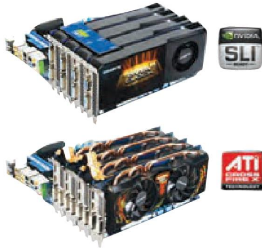
شکل ۸-۲۵ نصب کارت‌های گرافیک CrossFire و SLI
