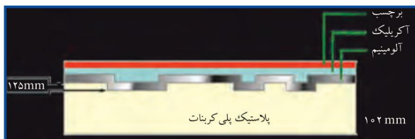
شکل ۳۶-۴ لایه‌های دیسک فشرده
