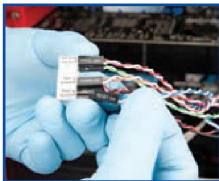
شکل ۸-۱۹ نصب و اتصال کانکتورهای پانل جلوی کیس
