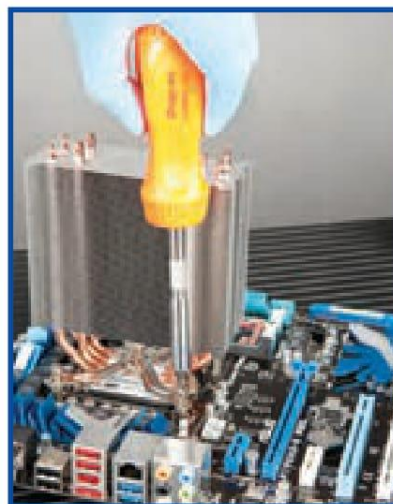
شکل ۸-۸ نمونه‌ای از نصب پایه خنک کننده
