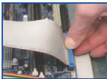
شکل ۸-۲۲ نصب کابل IDE
