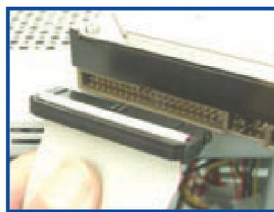
شکل ۸-۲۲ نصب کابل IDE
