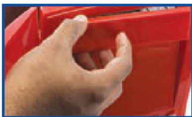
شکل ۲۰-۸ برداشتن پانل جلوی کیس
