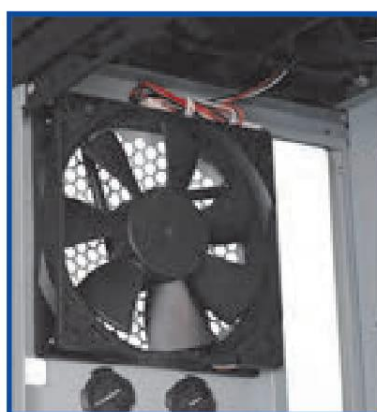
شکل ۸-۳ نصب پروانه خنک‌کننده کیس
