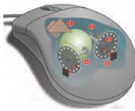
شکل ۲۶-۶ درون ماوس مکانیکی - نوری
