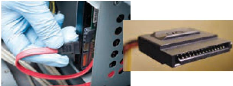
شکل ۸-۲۴ کابل برق و کابل انتقال داده‌های SATA و روش اتصال آن
