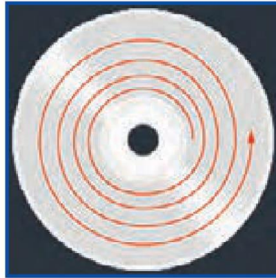
شکل ۳۵-۴ شیار دیسک فشرده
