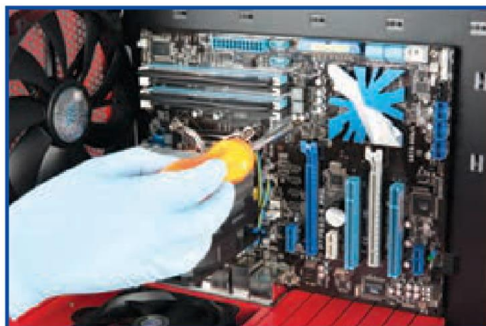
شکل ۸-۱۵ بستن پیچ‌های برد اصلی
