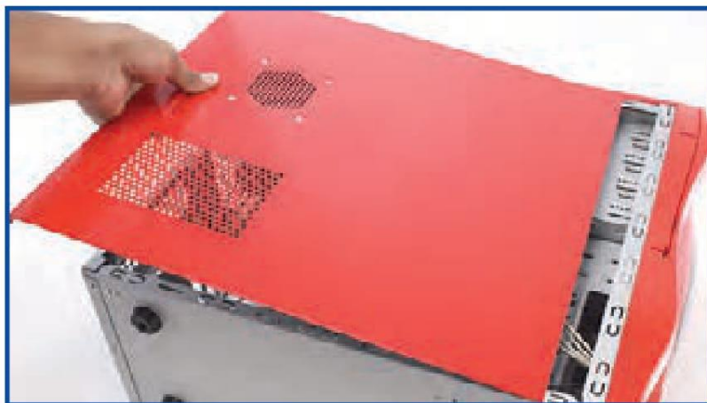
شکل ۸-۱ برداشتن قاب‌های جانبی
