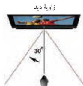
شکل ۸-۶ بهترین کیفیت تصویر برای این LCD، از دید عمود کاربر و تا زاویه ۳۰ درجه
