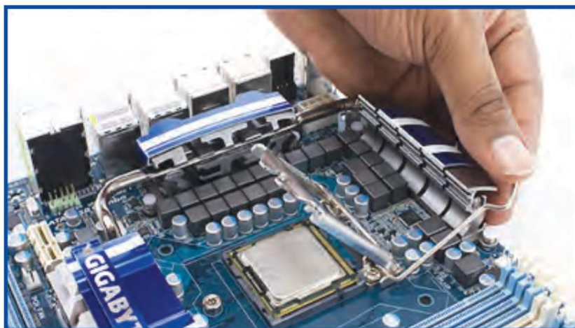
شکل ۸-۶ بستن پوشش فلزی سوکت پردازنده
