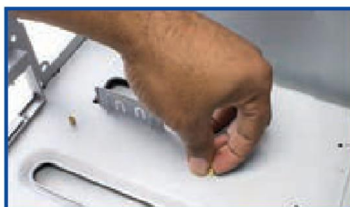
شکل ۸-۱۲ ثابت کردن پایه‌های برنجی
