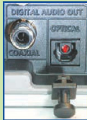
شکل ۵-۲۷ ورودی کابل نوری و کابل هم‌محور بر روی بلندگو
