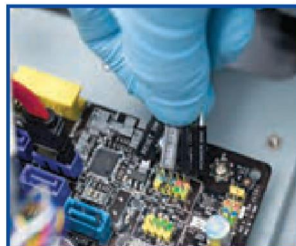
شکل ۸-۱۹ نصب و اتصال کانکتورهای پانل جلوی کیس
