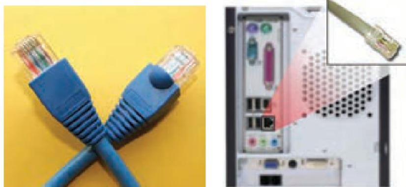
شکل ۳۵-۵ اتصال‌دهنده کابل شبکه در پشت کیس و سر کابل آن
