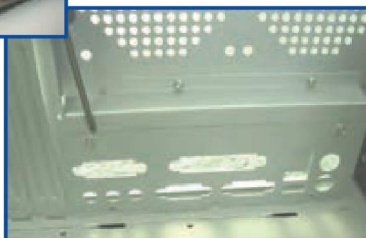
شکل ۸-۱۳ نصب پانل ورودی/خروجی
