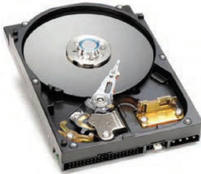
شکل ۲۹-۴ نمای داخلی دیسک سخت
