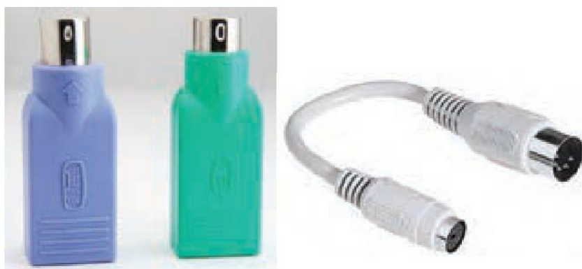
شکل ۲۲-۶ سمت راست، تبدیل کننده DIN پنج پین به PS/2 و سمت چپ، تبدیل کننده رابط USB به رابط PS/2 برای صفحه کلید و ماوس
