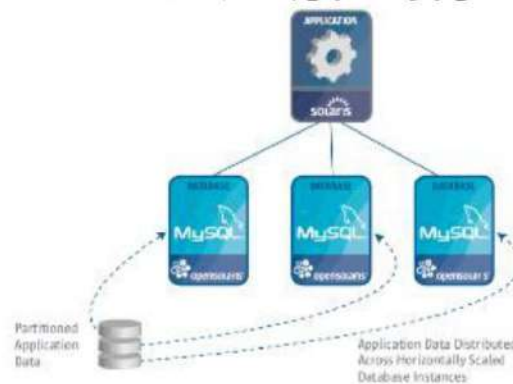
شکل ۷-۲- Database sharding با تقسیم کردن جداول پایگاه داده به چند پایگاه داده دیگر، از مقیاس‌پذیری افقی پایگاه‌های داده بزرگ پشتیبانی می‌کند
