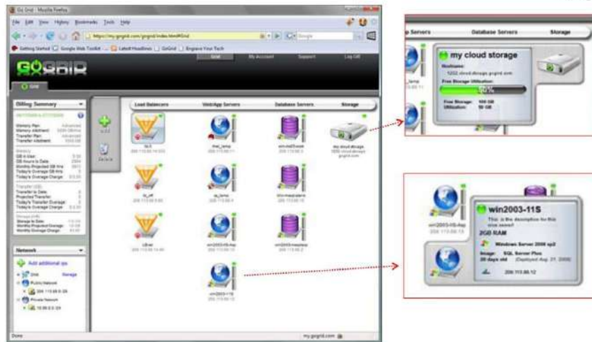
شکل ۱۰-۱- نمونه‌ای از زیرساخت ابری ارائه شده توسط GoGrid (سرورها می‌توانند مجازی یا فیزیکی باشند)
