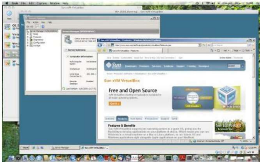
شکل ۱۴-۶- نمونه‌ای از اجرای سیستم عامل ویندوز در مکتینتاش با استفاده از Sun xVM VirtualBox [۱۱]
