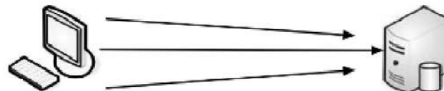
شکل ۱-۷- HTTP نیاز به چندین رویداد polling دارد تا وضعیت آن از مرورگر وب به روز رسانی شود
